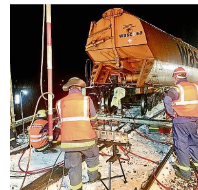
Helfer des THW mussten den Waggon mit Spezialtechnik in die Gleise befördern. Foto: privat
